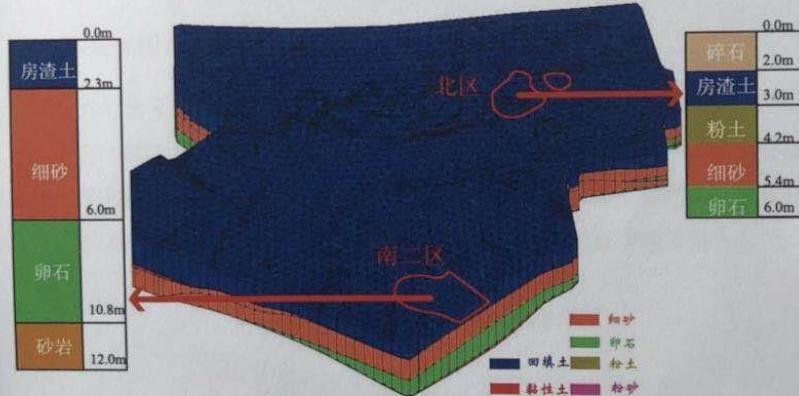
图 3-1 土层结构示意图
